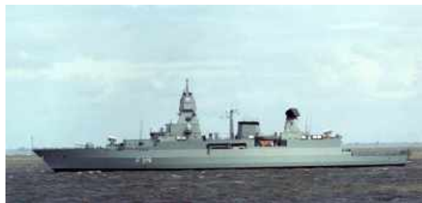
Figuur 20. Modern marine schip met APAR-mast en SMART-L
