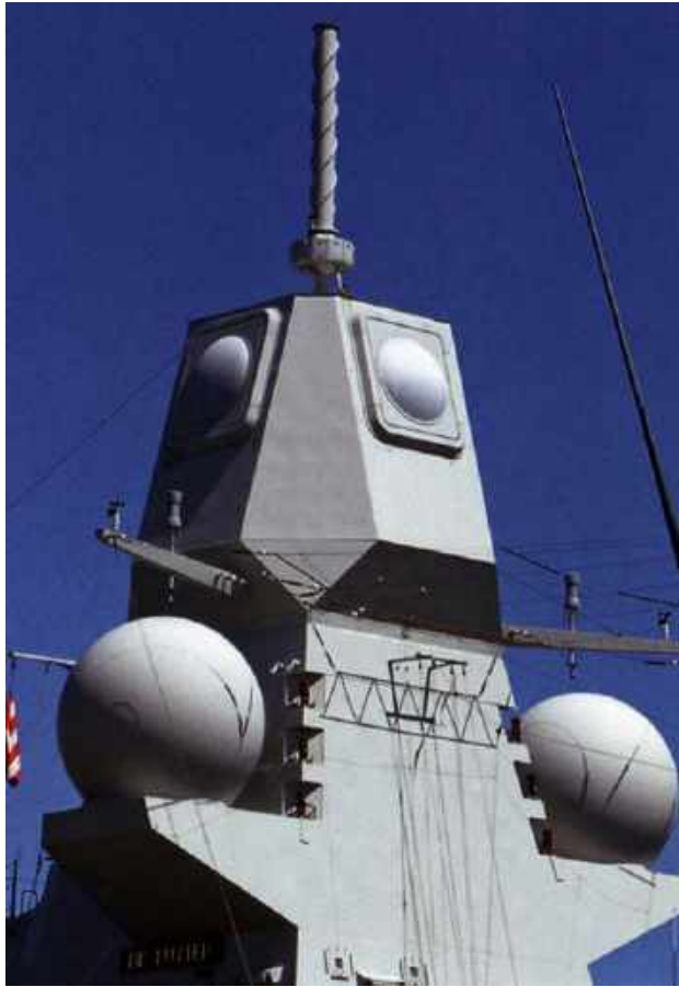
Figuur 19. MAST-module met APAR.
