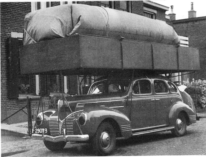
Auto met gasballon. Deze werd bij de gasfabriek gevuld. Door het benzine-gebrek was dit één van de mogelijkheden om auto's van brandstof te voorzien. Een andere mogelijkheid was de vergasser achterop waarin uit houtblokjes gas werd getrokken.
